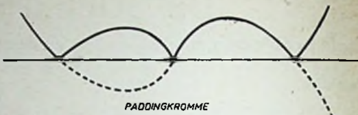
Fig. 2. Paddingkromme. Horizontaal is uitgezet de frequentie, waarop het toestel is afgestemd, verticaal de afwijking van de gelijkloop. Getrokken lijn: absolute waarde. Gestippelde lijn: werkelijke waarde.
